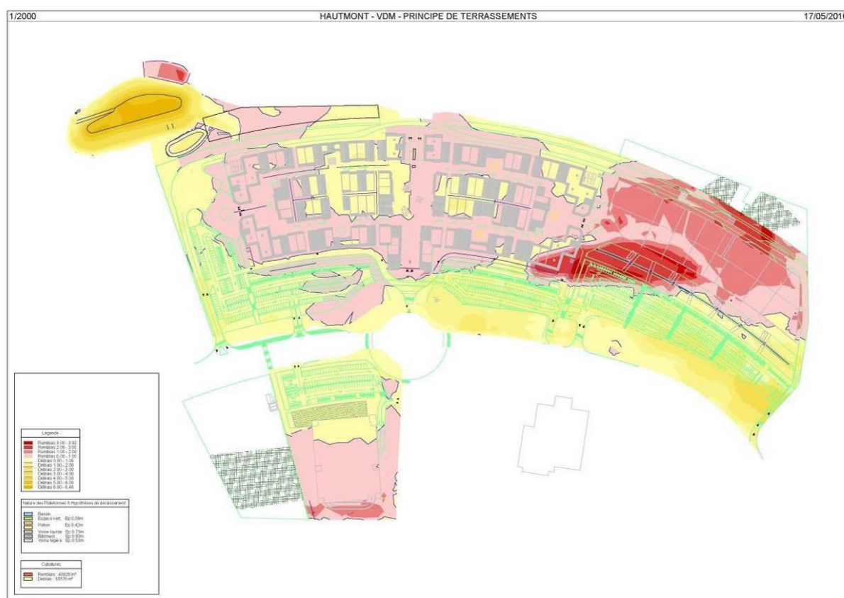
Carte 71 : Localisation des déblais (orange et jaune) et des remblais (rose et rouge) (Source : Projex Ingenierie – 20 avril 2016)
