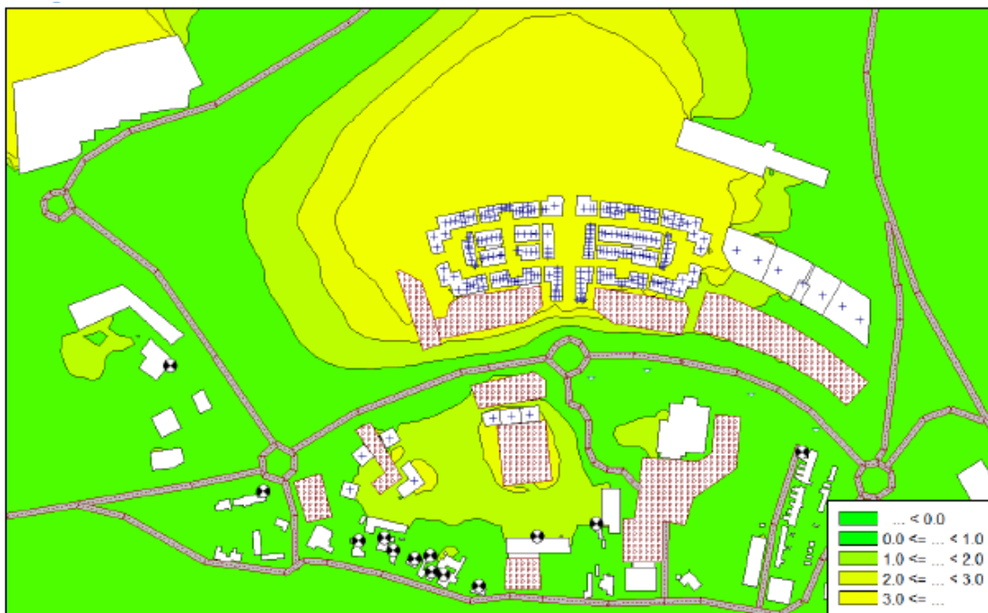
Carte 90 : Simulation de l'émergence de jour à l'état projet – Représentation par isophones
