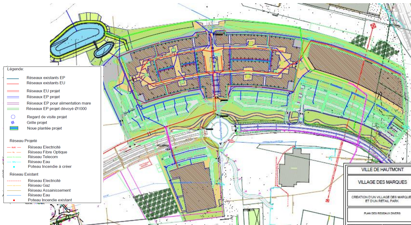
Figure 27 : Implantation du bassin de tamponnement, des noues et de la mare écologique
